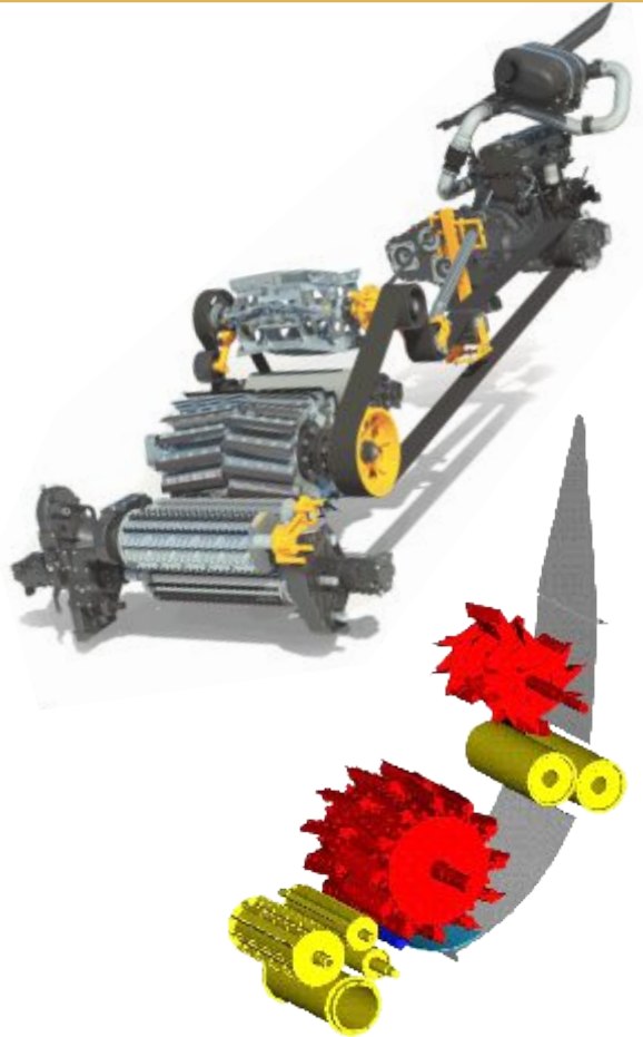
Figura 5: Detalle de componentes de la unidad de picado y diseño de flujo de material.
