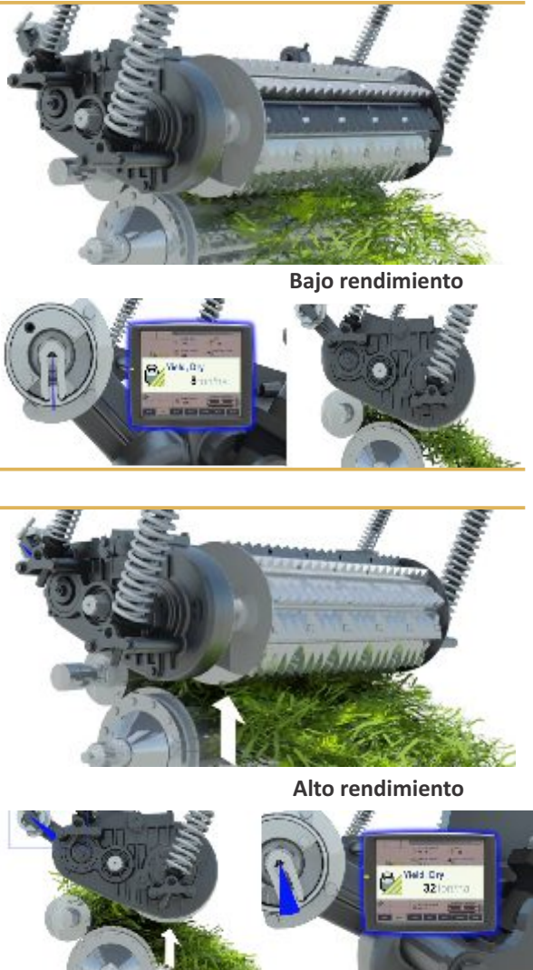
Figura 15: Esquema de funcionamiento del sensor de flujo.
