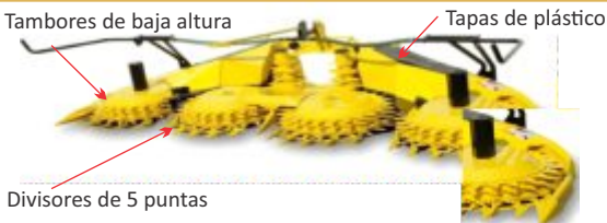
Figura 4: Cabezal de cuchillas contrarrotantes de surcos independientes, presenta la versatilidad de adaptarse a cualquier distanciamiento entre hileras de siembra e incluso cortando en sentido perpendicular a ellas
