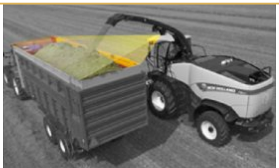
Figura 17: Sistema de guía automática de tubo de descarga.
