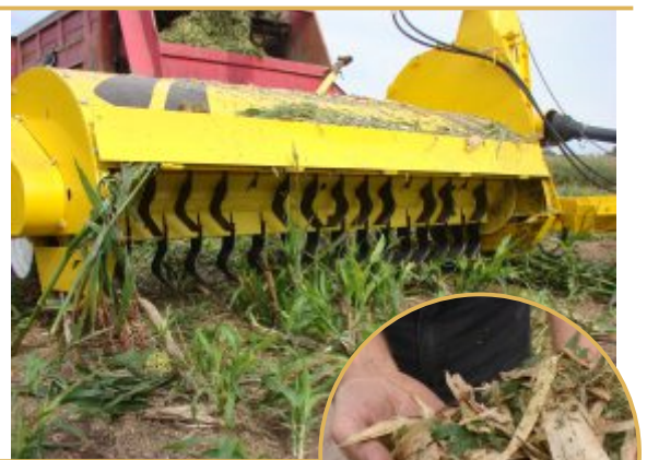
Figura 2: Máquina de corte picado directo de forraje con cuchillas largas de corte frontal, con el cual se logra un picado de más de 10 cm, preciso para realizar pastoreo mecánico pero no para alcanzar la calidad de picado necesaria para la confección de silo.
